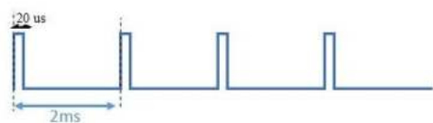
PMW con duty cycle del 1%
