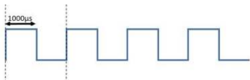
Onda quadra di periodo 20 ms (50 Hz)
